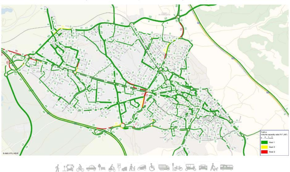
Figura 45. Ratio Intensidad/Capacidad IH8 - Detalle Arganda del Rey
