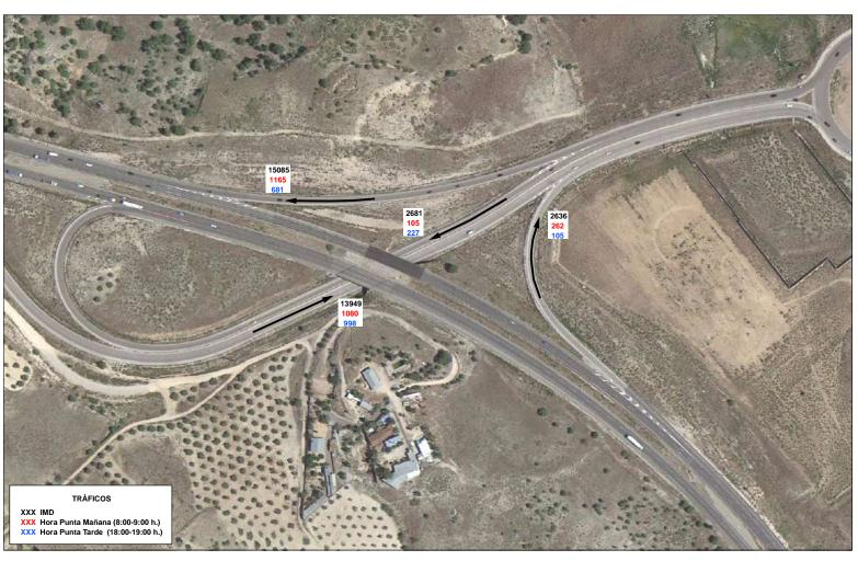
Figura 28. IMD e intensidades horarias de las horas punta en los puntos de aforo 7 y 8
