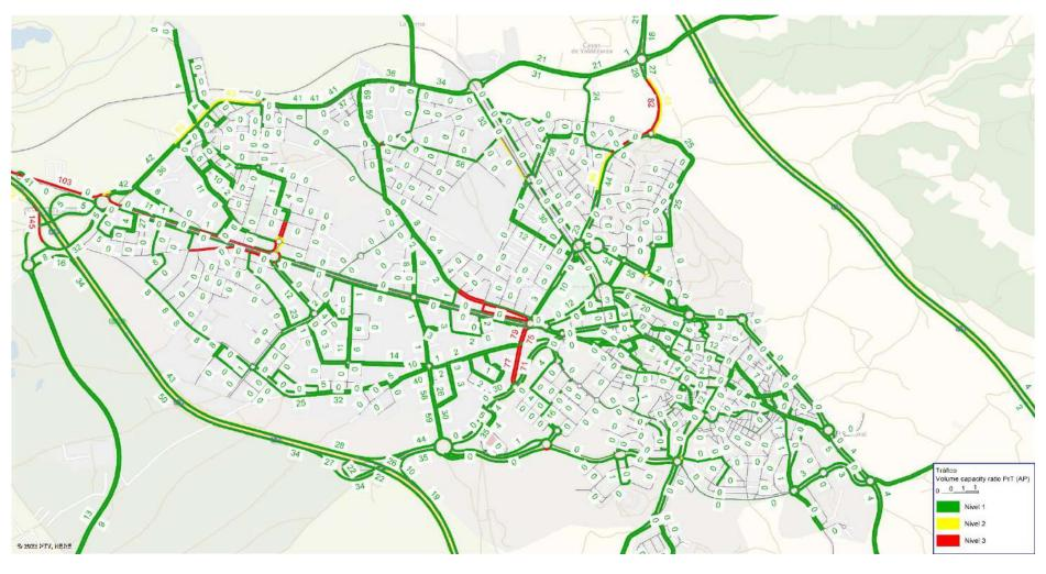
Figura 46. Ratio Intensidad/Capacidad IH18 - Detalle Arganda del Rey
