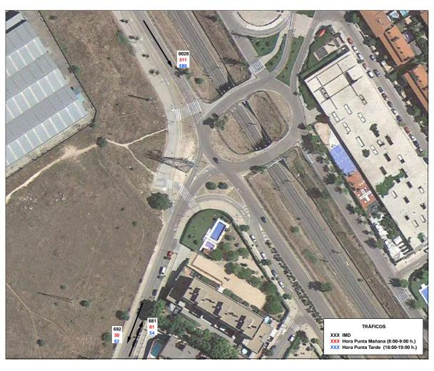
Figura 30. IMD e intensidades horarias de las horas punta en los puntos de aforo 10 y 11
