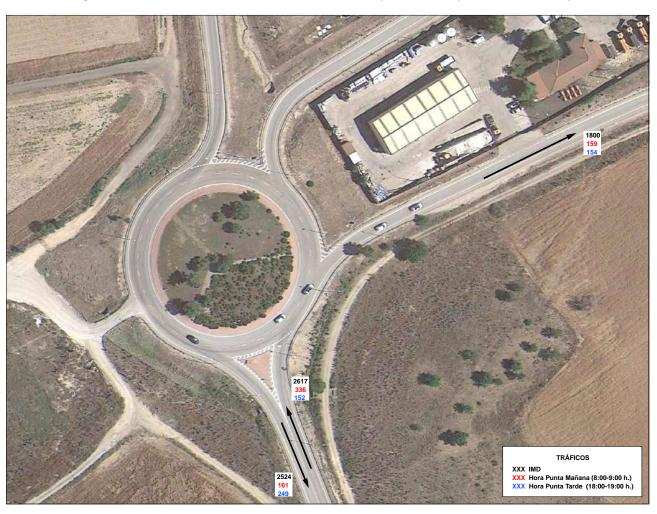
Figura 24. IMD e intensidades horarias de las horas punta en los puntos de aforo 1 y 2
