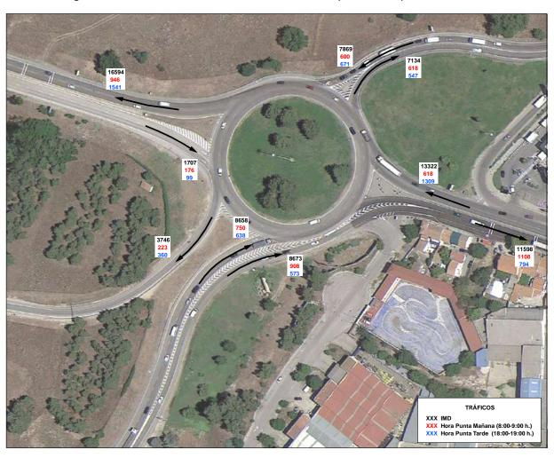
Figura 25. IMD e intensidades horarias de las horas punta en el punto de aforo 3
