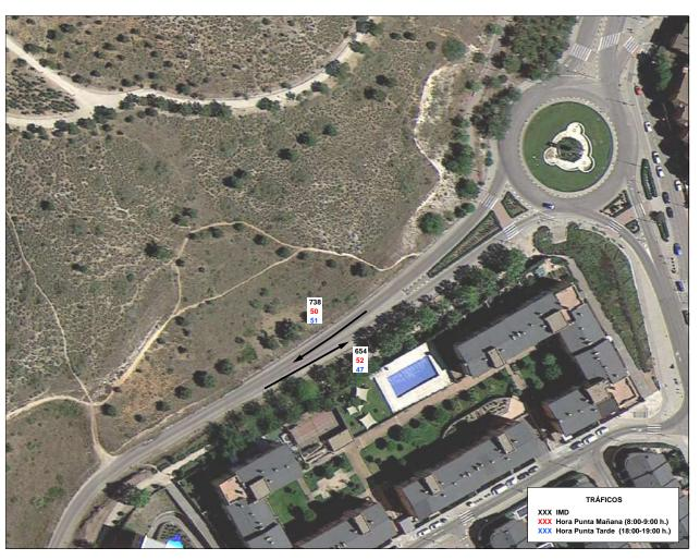
Figura 33. IMD e intensidades horarias de las horas punta en el punto de aforo 15
