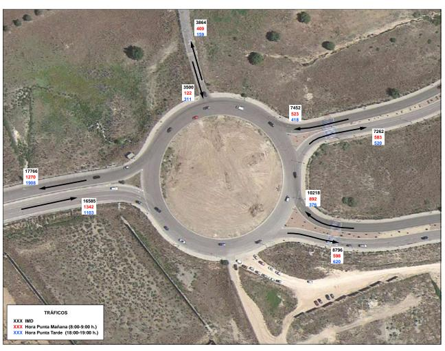
Figura 27. IMD e intensidades horarias de las horas punta en el punto de aforo 6
