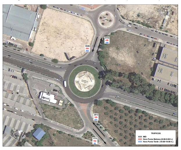
Figura 29. IMD e intensidades horarias de las horas punta en los puntos de aforo 9 y 12
